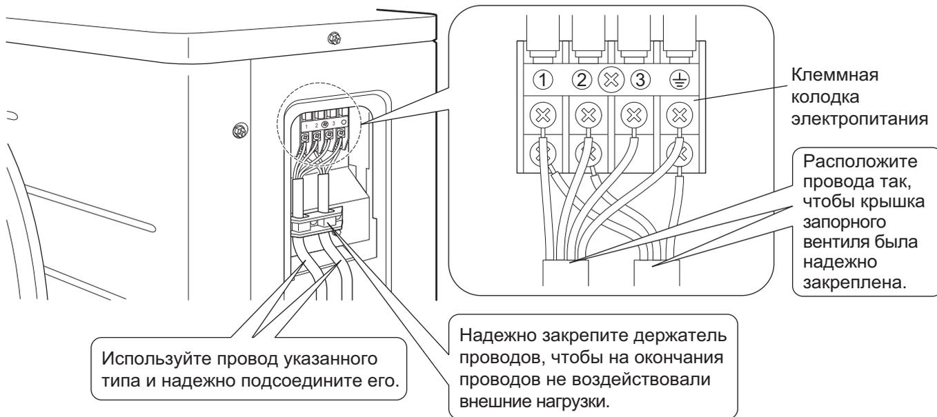
При подключении проводов к клеммной колодке источника питания обращайте внимание на приведенные ниже замечания. Меры предосторожности в отношении проводки источника питания.
