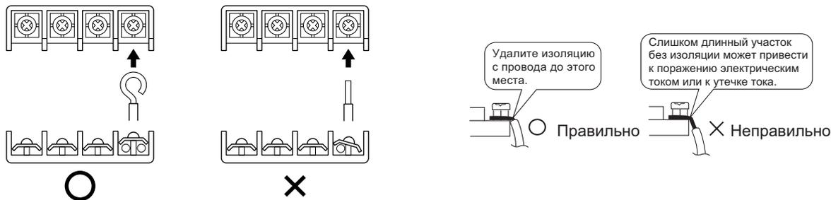
На стороне клеммной колодки снимите с провода изоляцию
