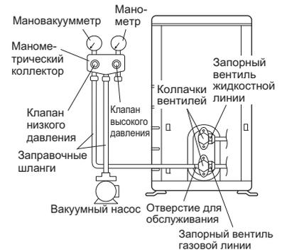
1) Подсоедините выступающую сторону заправочного шланга (идет от манометрического коллектора) к сервисному порту газового запорного вентиля.
