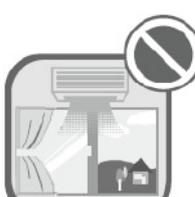
Для достижения максимальной производительности блока следует отключить нагревательные приборы, закрыть и зашторить окна.
