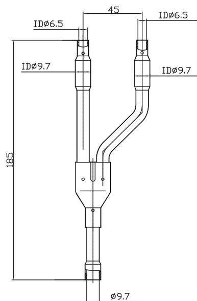
При необходимости обрежьте труборезом тройник в соответствии с нужным диаметром для соединительных труб. Место среза необходимо зачистить и обезжирить.
