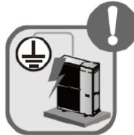
Оборудование должно быть заземлено во избежание поражения электрическим током и т.п.
