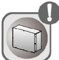
Во избежание поражения электрическим током все кабели, подключенные в электрическую коробку, должны быть закреплены.
