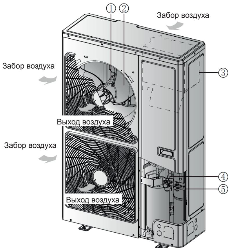
1 — мотор вентилятора; 2 — осевой вентилятор; 3 — электрическая коробка; 4 — запорный клапан газовой линии; 5 — запорный клапан жидкостной линии.
