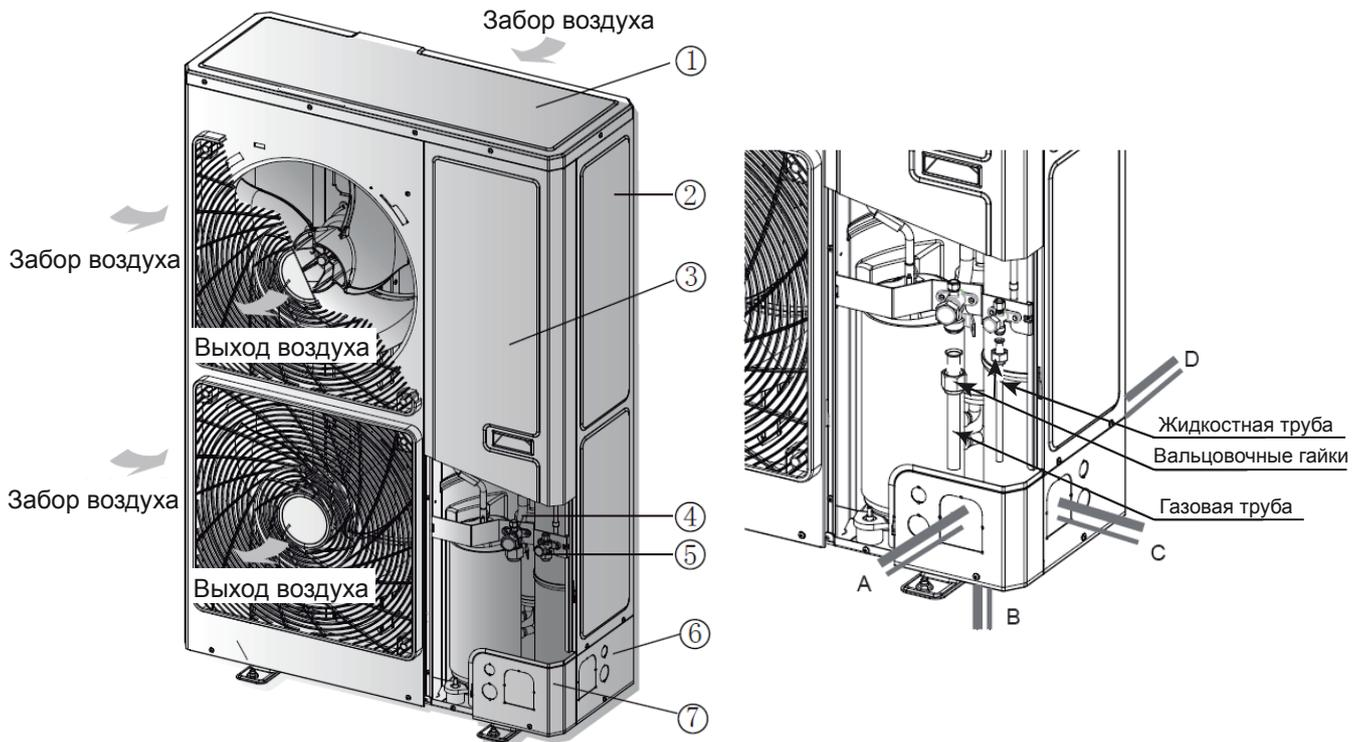
1 — верхняя крышка; 2 — боковая крышка; 3 — передняя крышка; 4 — запорный вентиль линии газа; 5 — запорный вентиль жидкостной линии; 6, 7 — перфорированные заглушки для подключения.
