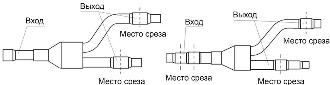
Разветвитель должен быть установлен в горизонтальном положении. Если устанавливаются два разветвителя, расстояние между ними должно быть не менее 500 мм.
