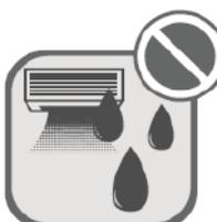
Во избежание коррозии отдельных элементов не рекомендуется устанавливать блок в помещении с высокой влажностью.
