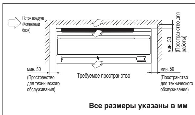
Прокладку трубопровода хладагента к блоку можно выполнить несколькими способами (с левой или с правой стороны на задней части блока), используя вырезанные отверстия на корпусе блока. Осторожно согните трубы для придания им необходимого положения и выравнивания с отверстиями. Для провода сбоку и внизу подведите трубы и расположите их в необходимом направлении. Сливной шланг для удаления конденсации можно прикрепить к трубам с помощью ленты.
