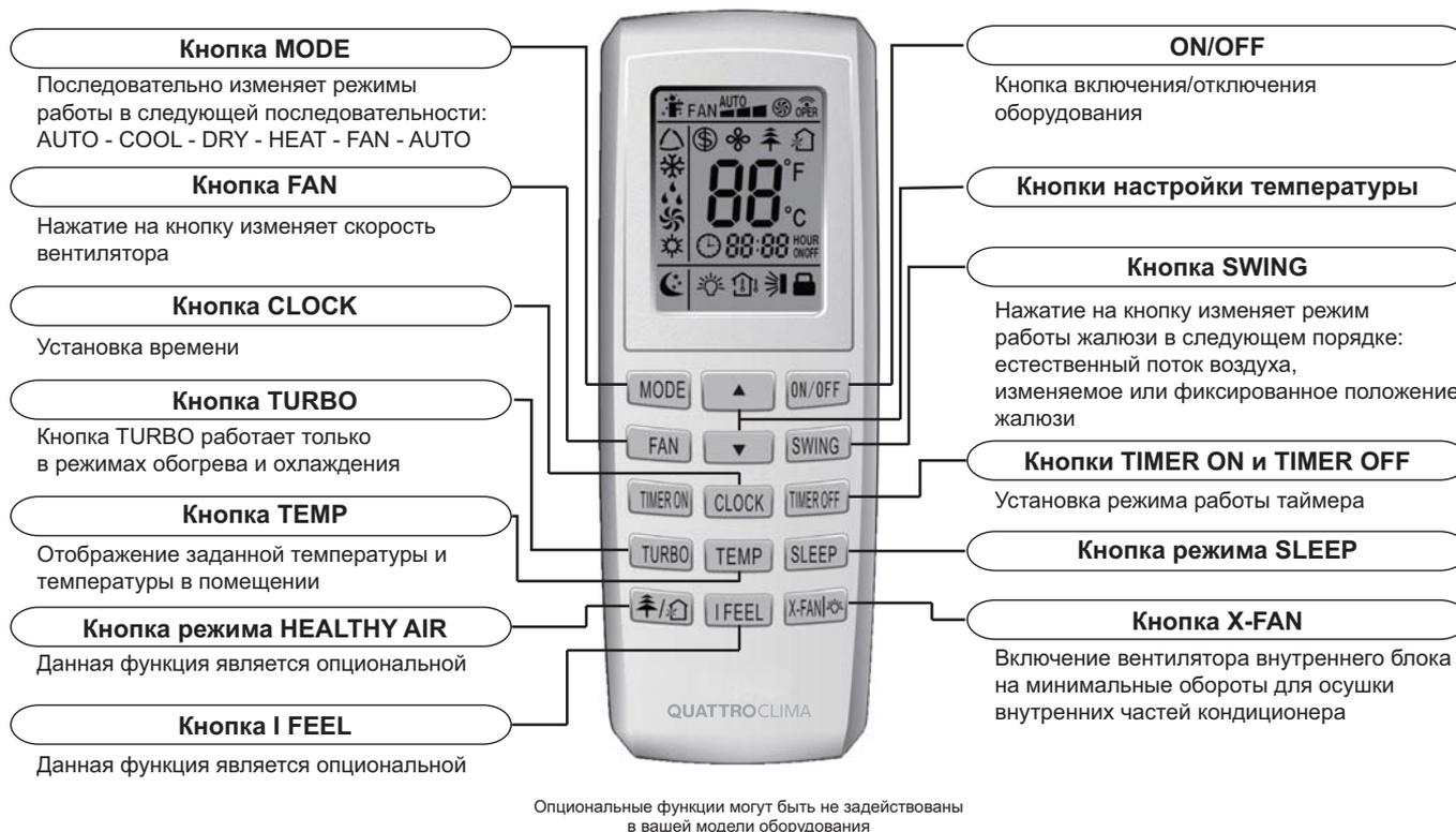
**HEAT**—режим обогрева. В этом режиме, если температура в помещении ниже заданной, то блок будет подавать в помещение теплый воздух. Если температура выше заданной, то блок будет работать в режиме вентиляции, т.е. будет работать только вентилятор внутреннего блока. Обратите внимание, что если задана скорость вращения вентилятора **AUTO** (автоматическая), вентилятор будет работать на минимальной скорости вращения, пока температура в помещении не понизится ниже заданной и не потребуются нагрев.
