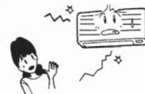
Для снижения нагрузки на элементы оборудования в кондиционере установлена 3-минутная задержка начала работы режимов «охлаждение» и «обогрев».
