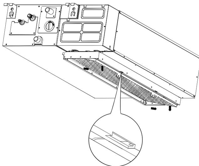
2. Смывайте грязь с сетки фильтра с помощью мягкого моющего средства, тряпки и воды до тех пор, пока визуально вы не увидите не одной пылинки.
