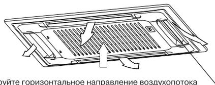
Отрегулируйте горизонтальное направление воздушного потока
