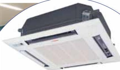
Стандартные кассетные внутренние блоки устанавливаются в подвесной потолок и обеспечивают равномерное охлаждение/обогрев помещения за счет подачи воздуха в четырех направлениях. Предусмотрена возможность подсоединения воздуховода для подмеса свежего воздуха в количестве 10% от общего объема рециркулируемого воздуха. Размер панели стандартной кассеты составляет 950×950 мм.
