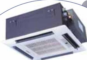
Компактные кассетные внутренние блоки предназначены для монтажа в подвесной потолок. Блок закрывается декоративной панелью размером 650×650 мм, которая является видимой частью кондиционера. Несмотря на компактные размеры, кассетные сплит-системы обеспечивают равномерный воздухообмен в помещении за счет четырех рядов распределительных жалюзи. Предусмотрена возможность подсоединения воздуховода для подмеса свежего воздуха в количестве 10% от общего объема рециркулируемого воздуха.
