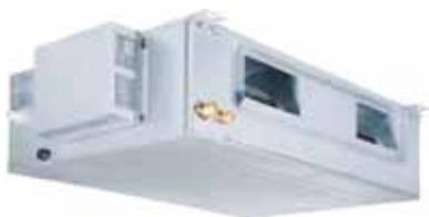
Канальные внутренние блоки устанавливаются за подвесным потолком и имеют возможность подмеса свежего воздуха. Объем подаваемого атмосферного воздуха может составлять 10% от общего объема, проходящего через внутренний блок.
