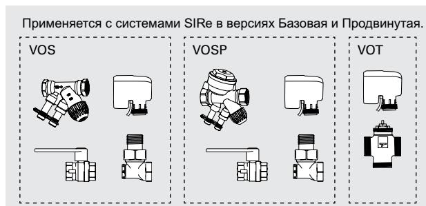
Комплекты клапанов VOS(P), VOT, VMO(P) или VMT используются для регулировки расхода, подробную информацию можно найти в разделе "Приборы управления".
