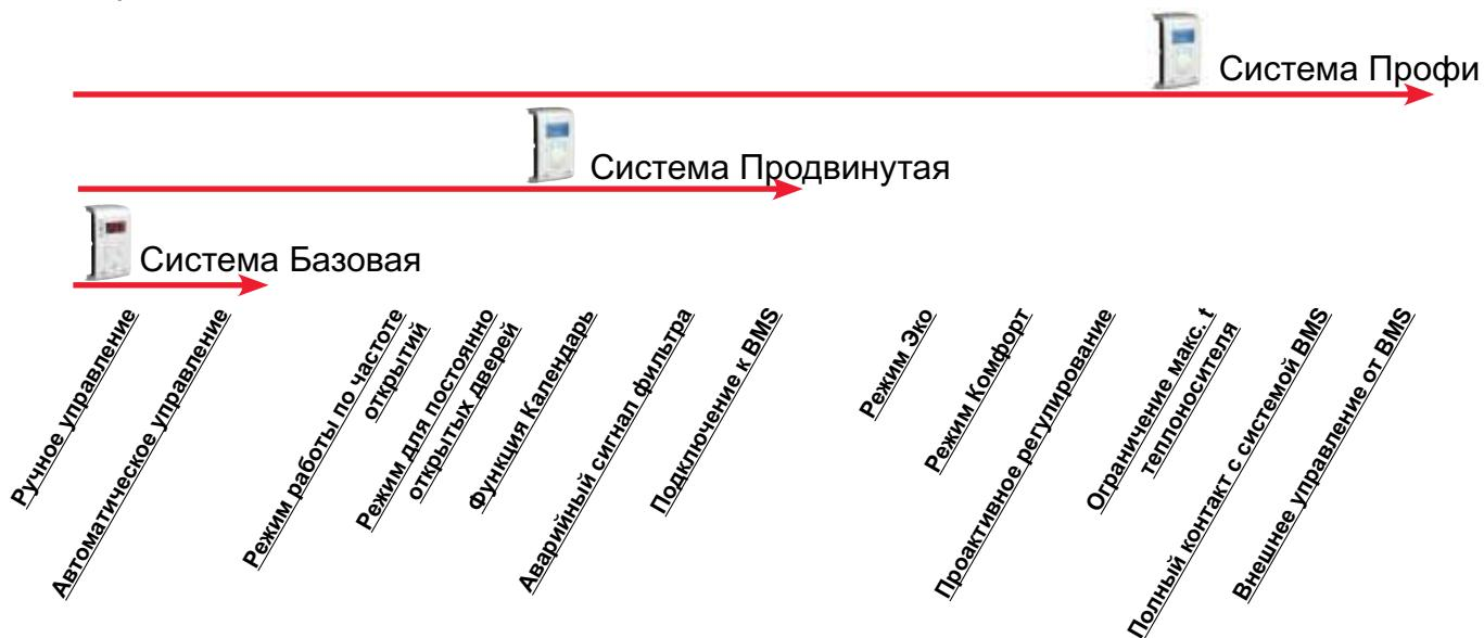
Данный вид завес поставляется со встроенной управляющей платой Базовая и температурным сенсором. В зависимости от тех функций, которые требуются, вы можете выбрать любую из 3х версий исполнения: Базовая, Продвинутая или Профи. Подробную информацию о системе управление SIRe можно найти в разделе "Приборы управления и принадлежности".
