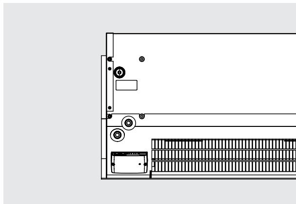
Управляющая плата Базовая и температурный сенсор SIReT устанавливаются внутри корпуса завесы.
